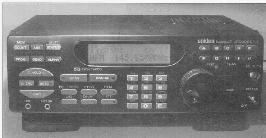
Het voorfront van de UBC9000XLT is zeer overzichtelijk; het centraal geplaatste dot matrix LCD scherm verschaft naast de ontvangen frequentie veel overige informatie. In een aantal knoppen liggen leds verscholen. Zeer fraai!
